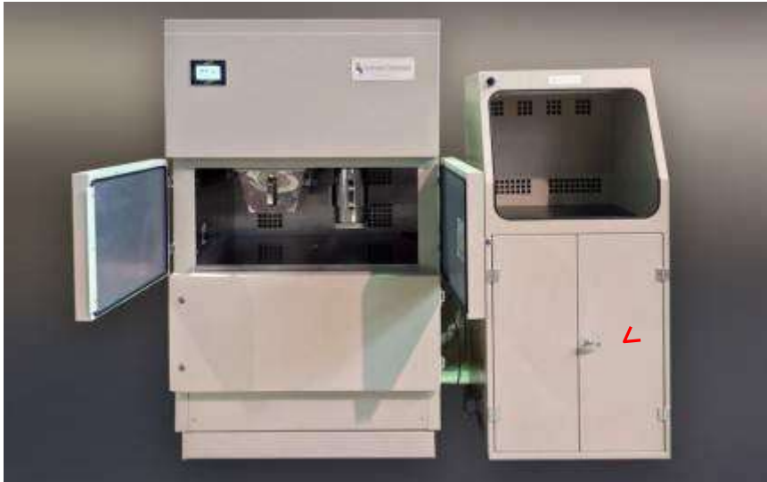
Aspiration avec filtration et décolmatage manuel.
